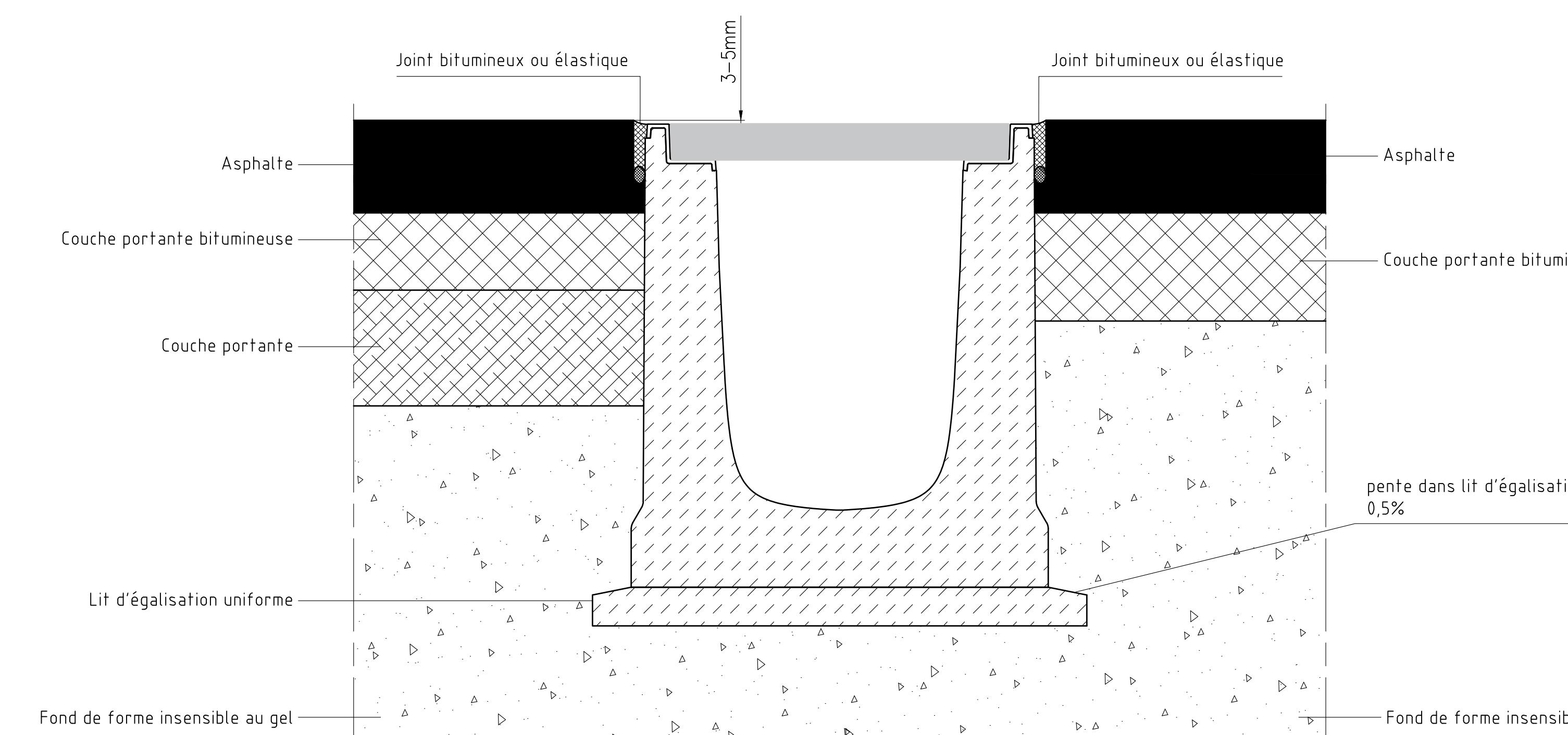
Réalisation des couches portantes et de fondation insensibles au gel (composition libre) conformément aux : "Catalogue des structures types de chaussées" / "Guide des terrassements routiers"
