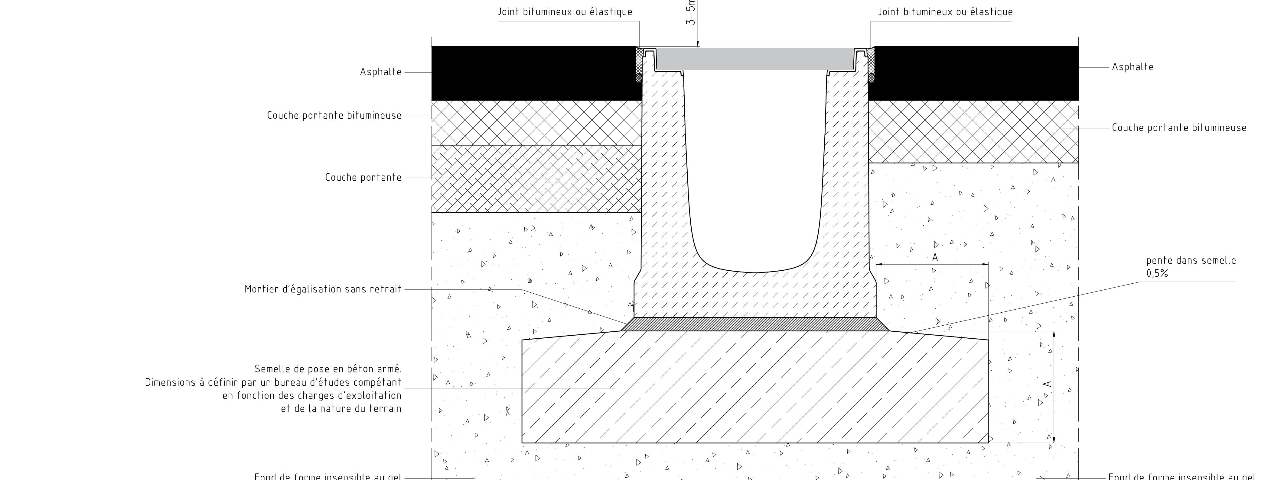
Réalisation des couches portantes et de fondation insensibles au gel (composition libre) conformément aux : "Catalogue des structures types de chaussées" / "Guide des terrassements routiers"
