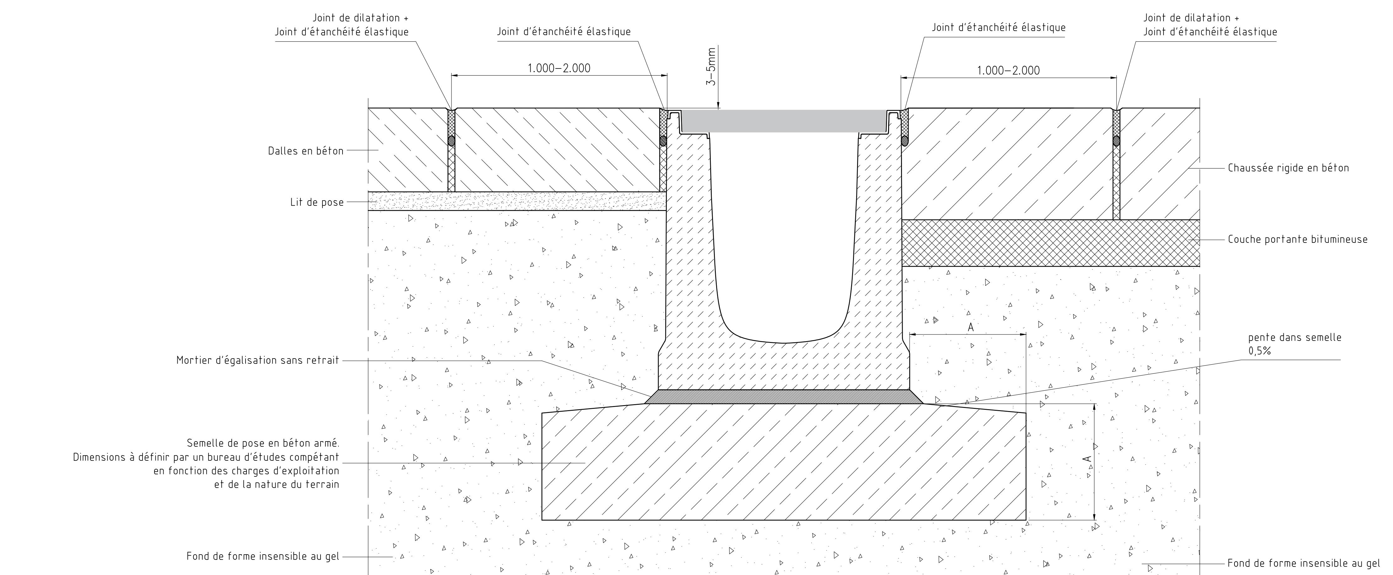
Réalisation des couches portantes et de fondation insensibles au gel (composition libre) conformément aux : "Catalogue des structures types de chaussées" / "Guide des terrassements routiers"
