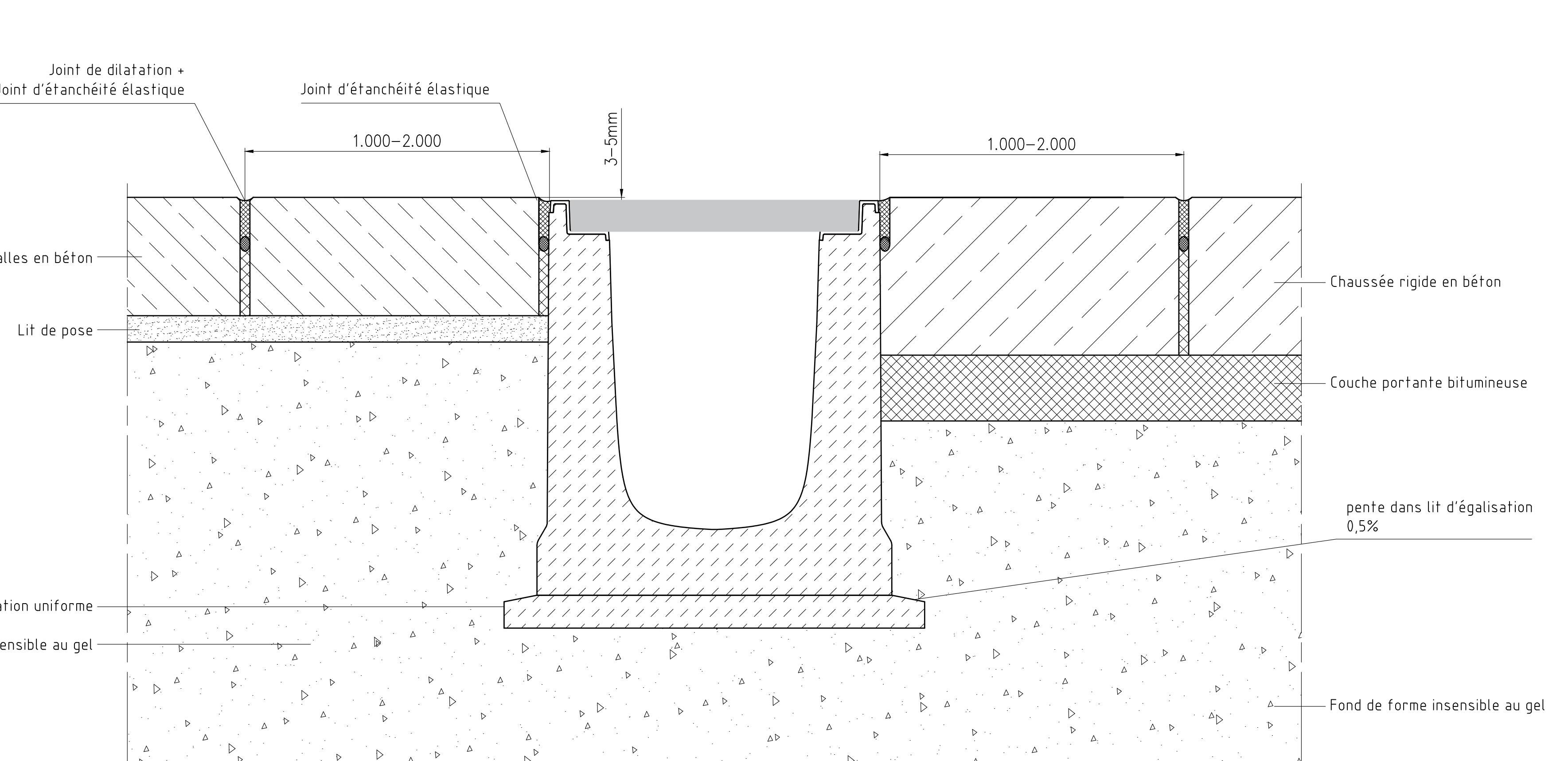
Réalisation des couches portantes et de fondation insensibles au gel (composition libre) conformément aux : "Catalogue des structures types de chaussées" / "Guide des terrassements routiers"
