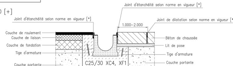
Montage suivant catalogue des structures types de chaussées avec des couches de fondation anti-gel (composition libre)
